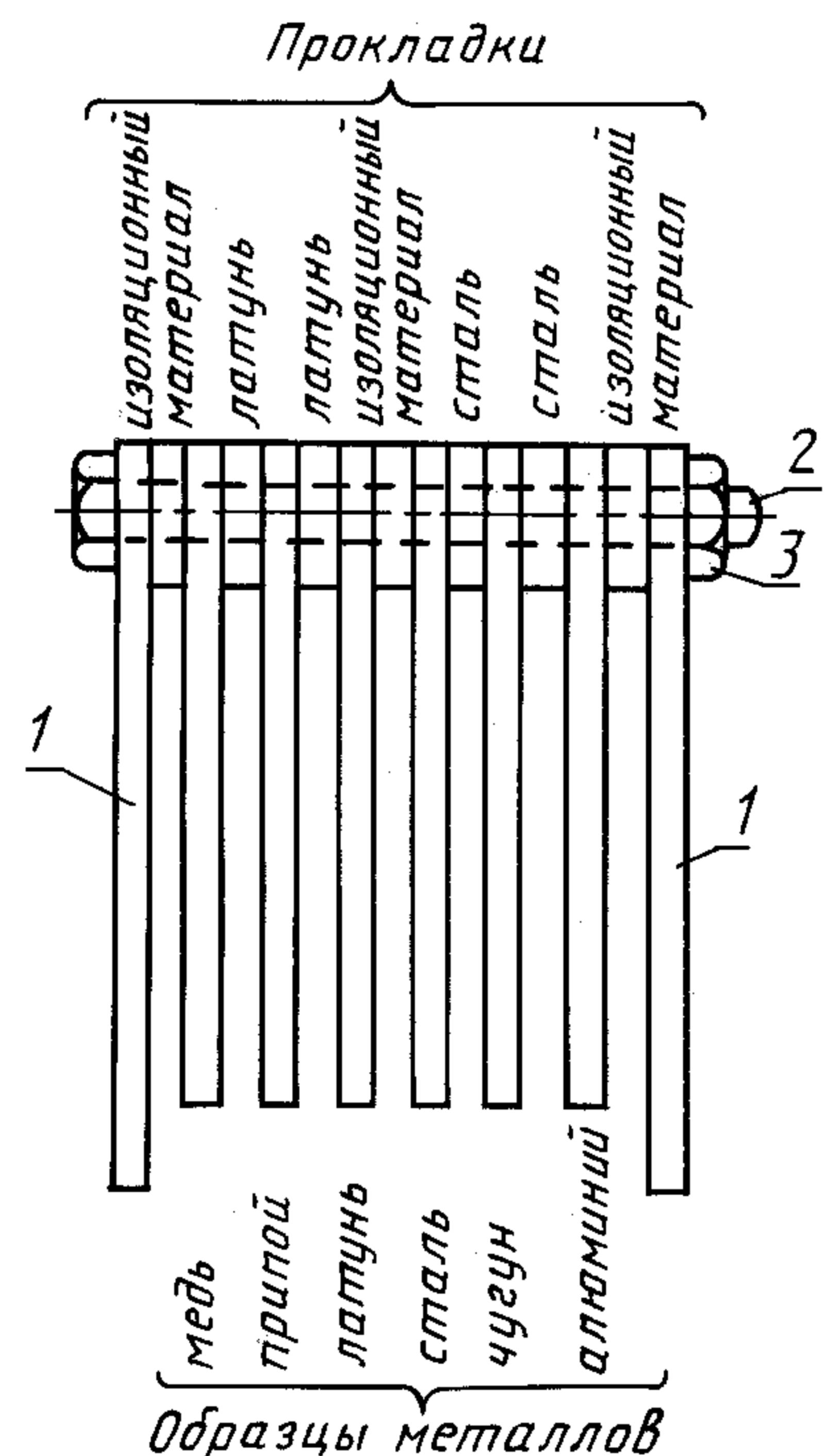
1 — латунные подставки; 2 — крепежный винт; 3 — гайка
